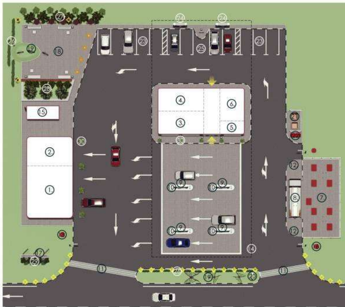
Тип 2. Схема планировочной организации автомобильно-заправочного комплекса
